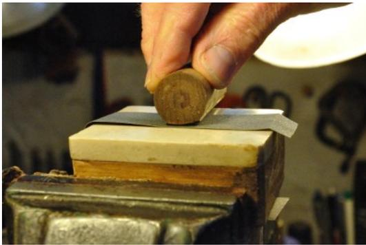
Basculer le bouchon vers la droite et vers la gauche pour conserver la bonne courbure. Il faut constamment contrôler la progression en insérant le bouchon dans la flûte pour vérifier sa hauteur et sa courbure qui doit être identique à celle du biseau, en dessous duquel seul un petit filet de lumière doit être visible.
