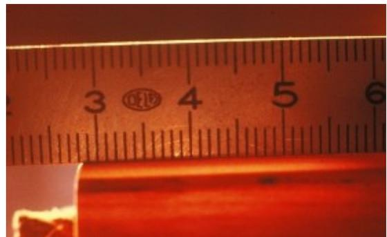
Le dessus du bouchon ne doit **jamais** être bombé, sinon la focalisation du flux d'air ne se ferait pas correctement vers le biseau. Si tel est le cas il faut racler la surface avec un couteau ou la limer pour lui rendre sa concavité (images ci-dessous).
