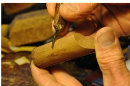
Il faut dans un premier temps enlever un peu de bois en dessous du bouchon afin qu'il puisse se placer plus bas. Cela peut se faire en raclant le bois avec un couteau ou un racloir, ou encore en utilisant une lime.
