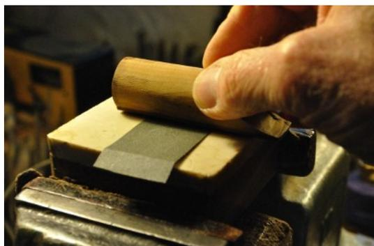
Placer une bande de papier abrasif fin (grain 320), de largeur inférieure de moitié au moins à la longueur du bouchon sur une surface absolument plane.
